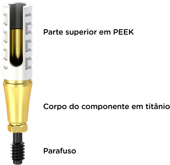
FIGURA 1: Modelo esquemático das partes que compõe o Provisório.
